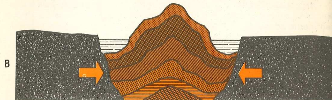
Fig. 81. Anticlinal și sinclinal. Observați că la suprafață sinclinalelor le corespund depresiunile, iar anticlinalelor, zonele înalte, boltite.
